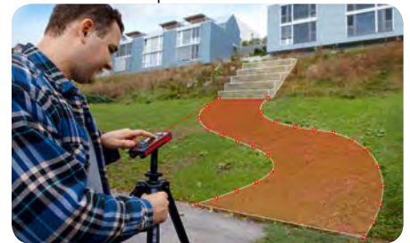
Relevé de points et de surfaces
